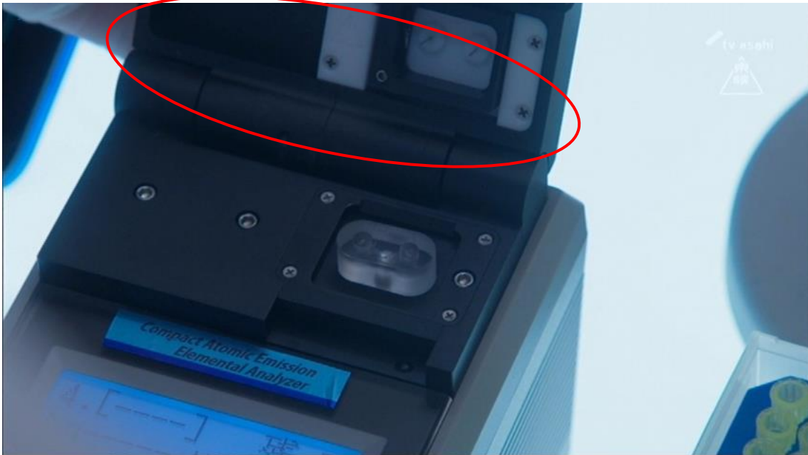
画面（4） フタ閉め MH-5000 のフタを閉めると、測定準備完了
